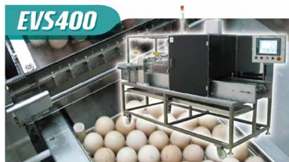
図1 孵化途中卵検査装置 EVS400
